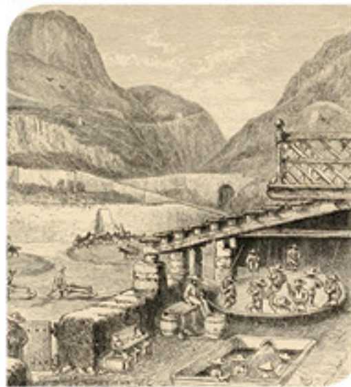
3.37. Método de patio para el beneficio de la plata. Anónimo siglo XX.
